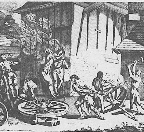
L'inserimento del cerchione attorno alla ruota (da Diderot e D'Alembert, "Encyclopédie", vol. II, Paris. Recueil de Planches sur les Sciences... Art Méchanique, II e VII, Paris 1762-72).
