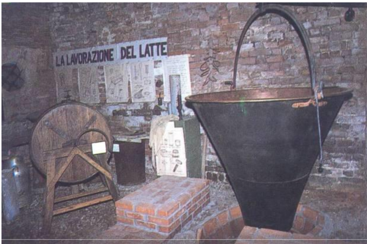
La grande caldaia in rame per la preparazione del formaggio grana, dono del Lions Club di Codogno.
