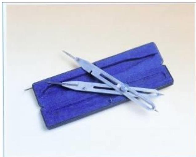
Compasso geometrico risalente a circa il 1940: esso porta la cerniera in posizione intermedia. Esso è contenuto in una scatola con la dicitura "Ecobra". Questo strumento è utilizzato per variare la scala di un disegno o per dividere un segmento in parti uguali.
