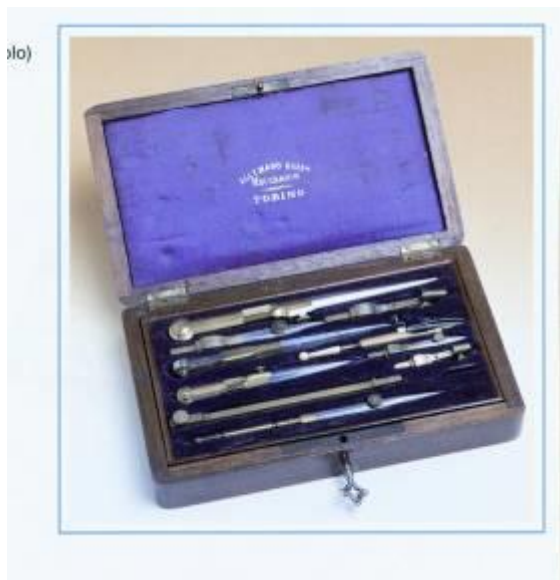
Scatola di compassi della fine del XIX secolo, costituita da undici pezzi in acciaio e ottone e contenuta in una scatola di legno. La scatola, rivestita internamente di velluto, è di grande validità estetica. È possibile osservare la scritta "Alemanno Giuseppe Meccanico Torino"
