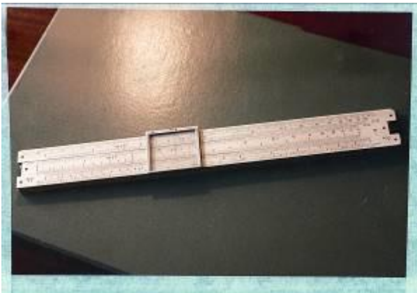
Regolo calcolatore degli anni Venti, con base 250 mm. Il regolo calcolatore, incontrastato strumento di calcolo di ingegneri e tecnici fino al 1970, è basato sui logaritmi ed è costituito da una parte fissa, da una scorrevole e da un cursore. Allineando tali elementi, è possibile compiere un gran numero di operazioni, con approssimazioni dell'ordine del 5%.
