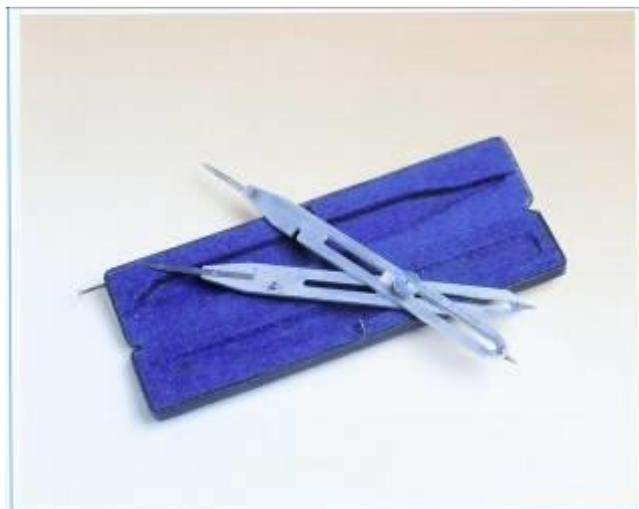
*Compasso geometrico risalente a circa il 1940: esso porta la cerniera in posizione intermedia. Esso è contenuto in una scatola con la dicitura "Ecobra". Questo strumento è utilizzato per variare la scala di un disegno o per dividere un segmento in parti uguali.*
