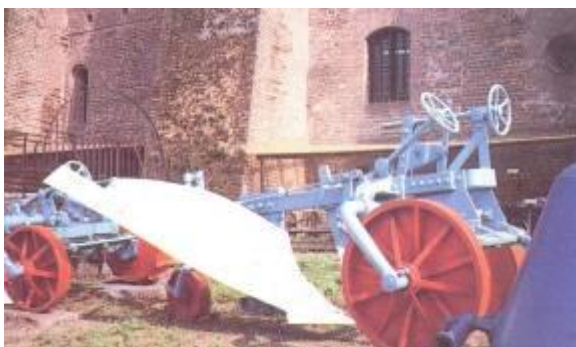
Poderoso aratro da scasso usato durante la bonifica nel Ferrarese degli anni Venti/Trenta.
