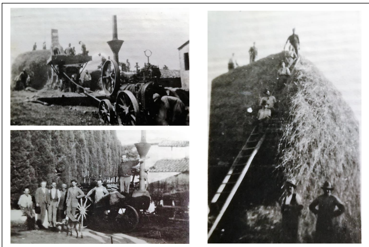
A sinistra in alto: trebbiatrice azionata da locomobile a vapore (Pian di Sala); in basso: locomobile a vapore (fattoria di Citerna). A destra: grande cumulo di paglia (Pian di Sala).
