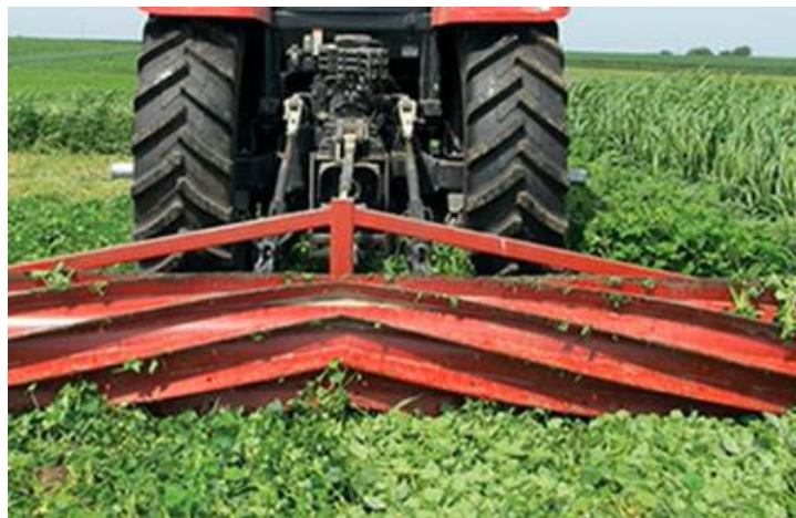
Figura 3 - Rullo a superficie scanalata per la devitalizzazione delle colture di copertura
