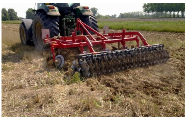
Figura 16 - Erpici combinati per la minima lavorazione
