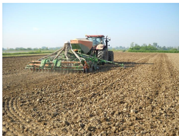
Figura 10 - Semina interrata a file con seminatrice pneumatica.
