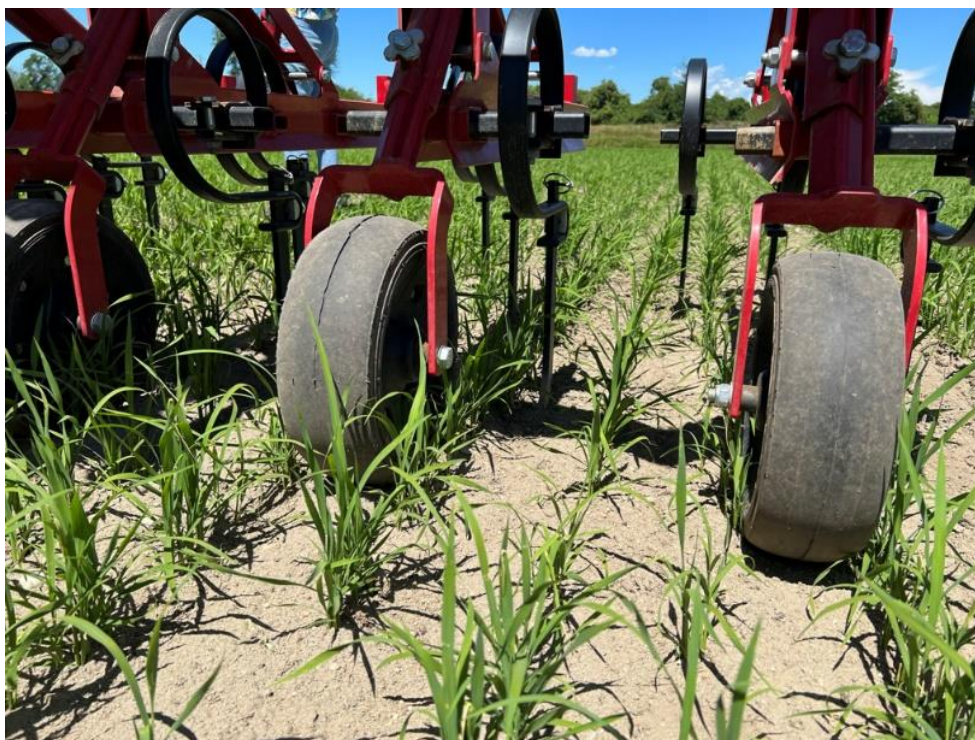
Figura 12. Particolare di sarchiatrice in grado di operare nell'interfila del riso seminato a file distanti 15 cm.
