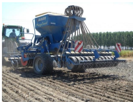
Figura 15 - Macchina combinata per minima lavorazione e semina interrata a file del riso.
