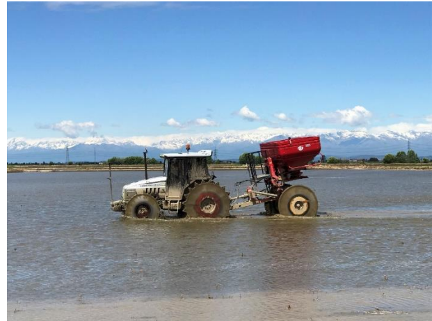
Figura 5 - Semina a spaglio del riso, in risaia allagata, tramite spandiconcime centrifugo
