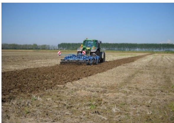
Figura 14 - Minima lavorazione del terreno con organi lavoranti trainati senza ausilio della presa di potenza
